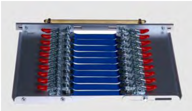
Mehrfachbänderrahmen für 10 Bändchen bis 26 mm für 6 Bändchen bis 40 mm für 4 Bändchen bis 60 mm für 3 Bändchen bis 80 mm Höhe
