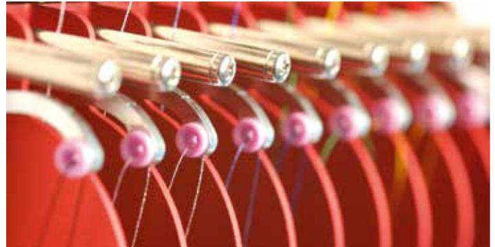
Die spezielle Kassettentechnik der Fortron-Maschinen ermöglicht eine sehr schnelle Kreisbewegung zum Antrieb der Nadeln. (Fotos: Stickmaschine.de)
